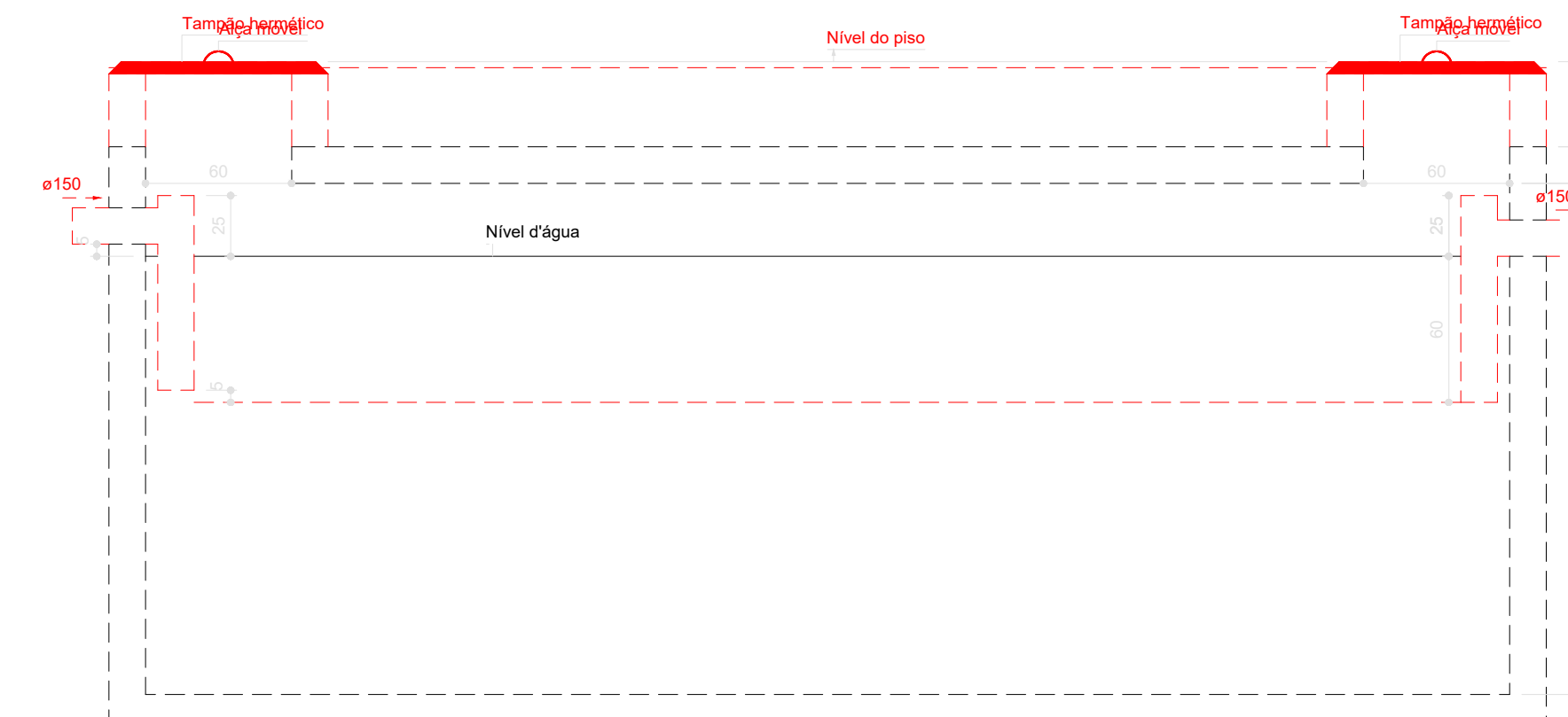
Tanque séptico - Pavimento Térreo Corte 1 - ESC. 1:25
