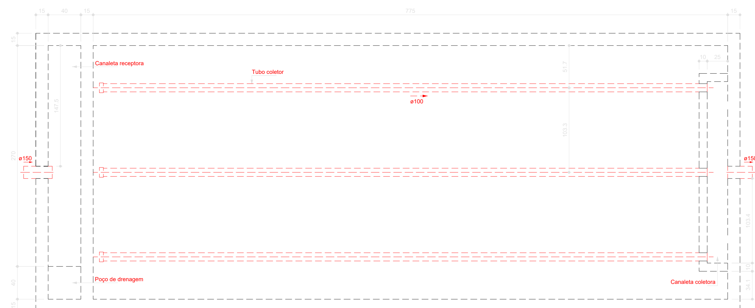
Filtro anaeróbio - Pavimento Têrreo Planta baixa - ESC. 1:25
